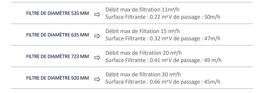
GRANULOMÉTRIE DU SABLE: 0,5 À 0,8 MM CE SONT DES FILTRES MULTICOUCHES
